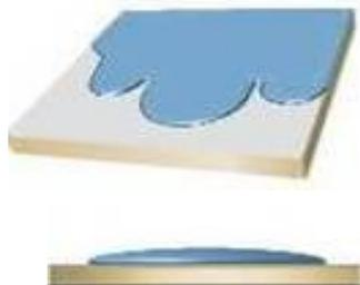
基材に水がはじかなくなり、ベターと伸び広がる状態。汚れの下に水が入り込み、汚れを浮かせて洗い流すセルフクリーニング効果と視界くっきりハッキリくもり防止効果が得られます。さらに、土埃や汚れを帯電防止機能で寄せつきづらくすることでさらに汚れが付くのが少なくなります。
